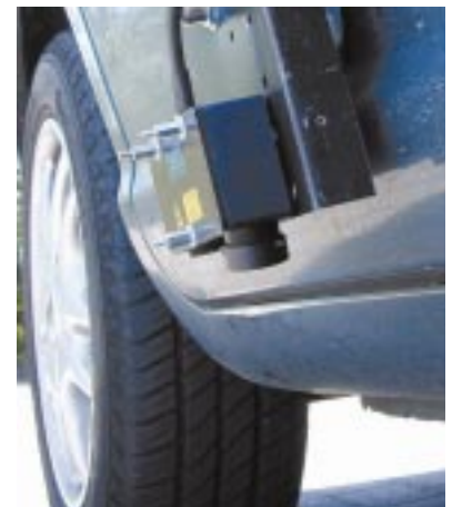
Meten van inverting op verschillende wegoppervlakken
